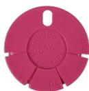
Pour les instruments PIEZON®, contrôlez régulièrement la longueur et la pointe de l'instrument à l'aide de l'outil de vérification de l'instrument PIEZON®. Si l'extrémité de l'instrument PIEZON® atteint la limite matérialisée par le logo GBT ou se trouve en dessous, elle peut présenter une vibration excessive non contrôlée. Remplacer l'instrument PIEZON®.
