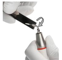
Serrez avec précaution l'écrou-raccord à l'aide de la clé plate.
