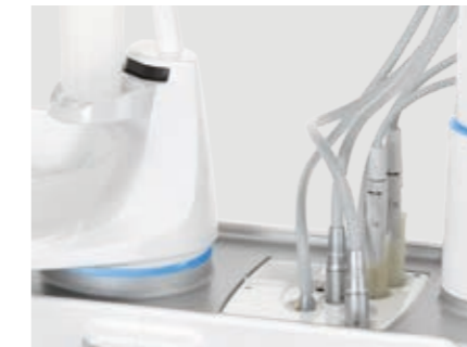
I.W.F.C. Activé par la console, le dispositif assure le rinçage automatique des conduites après un arrêt prolongé de la machine. Il est compris dans le système BIOSTER ou bien disponible en option.
